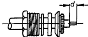
Druckschraube, Unterlegscheibe Dichtungsring und Klemmring auf das Kabel schieben (Klemmring nur bis zum Kabelmantel) und Abschirmgeflecht über Klemmring zurück biegen. Maß „d“ kontrollieren. Gegebenenfalls Dielektrikum zurückschneiden.
