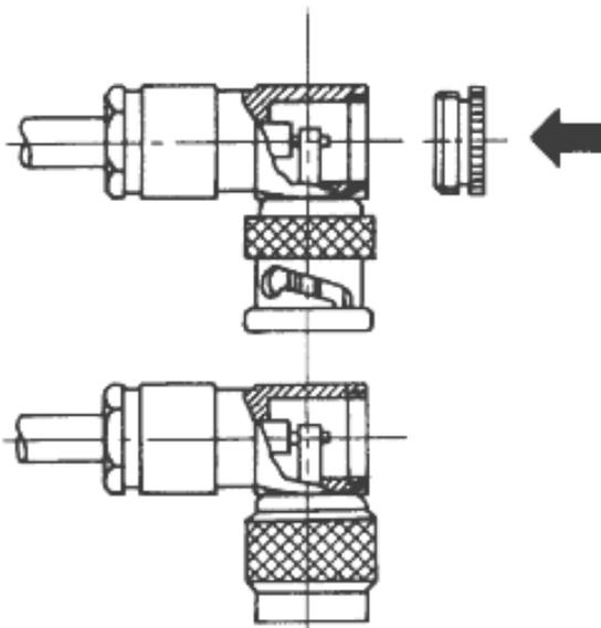
Kabel so weit wie möglich in Steckeranschluss eindrücken und Druckschraube fest anziehen. Überschüssiges Lot entfernen. Verschlusschraube fest verschrauben.
