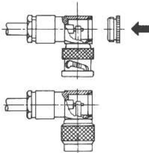
Kabel so weit wie möglich in Steckeranschluss eindrücken und Druckschraube fest anziehen. Innenleiter mit Kontaktstift verlöten. Überschüssiges Lot entfernen. Verschlusschraube fest verschrauben.
