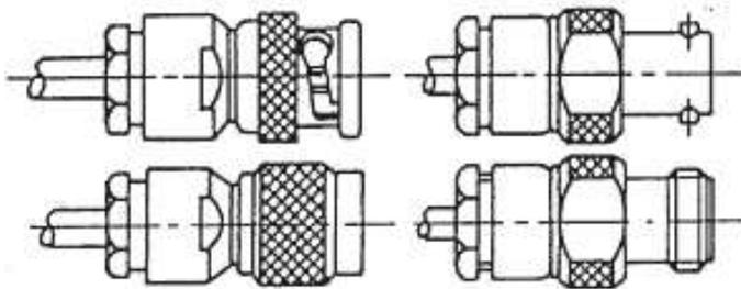
Kabel so weit wie möglich in Stecker- bzw. Buchsenanschluss eindrücken und Druckschraube fest anziehen.
