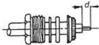
Druckschraube, Unterlegscheibe, Dichtungsring und Klemmring auf das Kabel schieben (Klemmring nur bis zum Kabelmantel) und Abschirmgeflecht über Klemmring zurückbiegen. Maß „d“ kontrollieren, gegebenenfalls Dielektrikum zurückschneiden.
